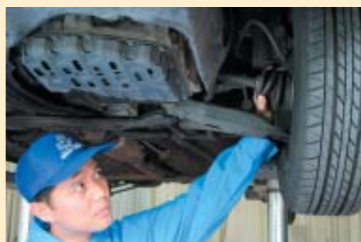
＜ドライブシャフト＞ ドライブシャフトのダストブーツの亀裂、損傷をチェック！
