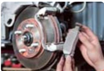
ディスクブレーキのキャリバを外してパッドの摩耗を点検します。
